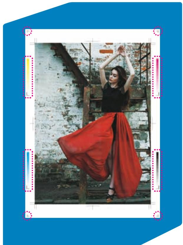
Stampa, scansione e analisi automatiche dei segni di registrazione fronte-retro e delle barre di gradiente.
